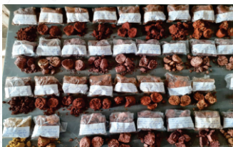
Coletas de amostras de ensaios de sondagens SPT.
