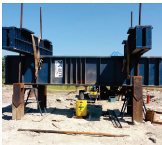
Prova de carga estática (PCE) no porto de Santos-SP.
